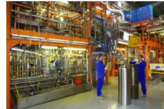
Vue générale du prototype de vitrification en creuset froid à Marcoule
