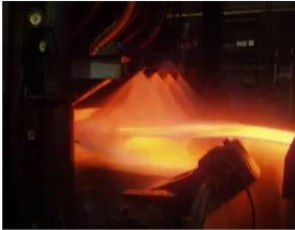
Utilisation industrielle de refroidissement par spray à haute température
